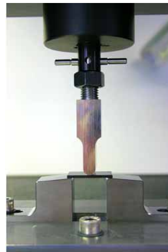
Abbildung 22: 3-Punkt-Biege-Apparatur mit eingelegtem Probekörper
