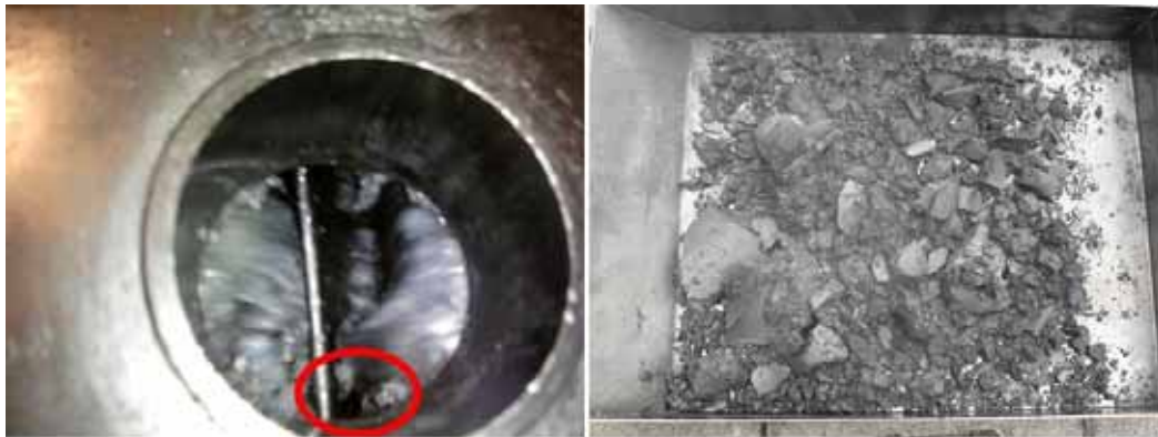
Abbildung 33 Unaufgeschmolzene Polymerpartikel (links) und qualmendes Compound (rechts)
