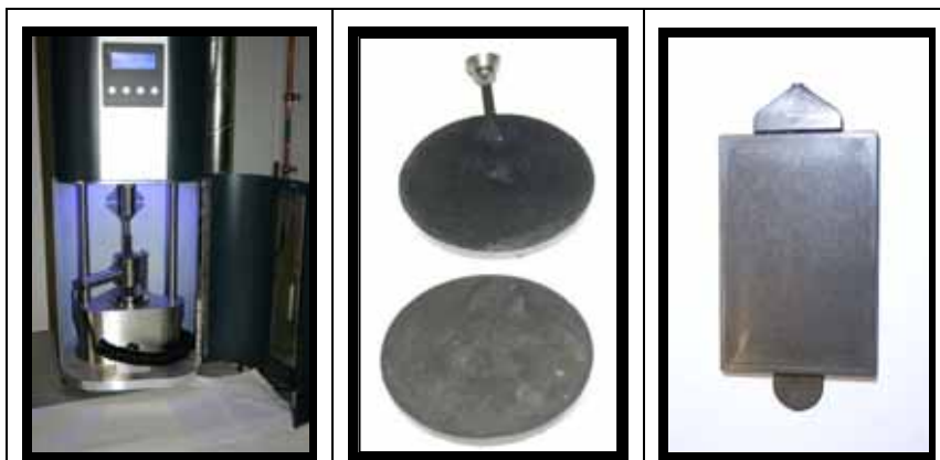
Abbildung 20: Kolbenspritzgießmaschine Haake MiniJet II und Probekörper
