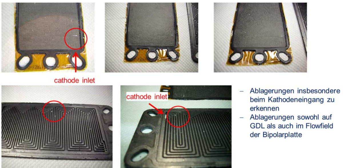
Abbildung 34: Untersuchung des Stacks nach Partikelzugabe
