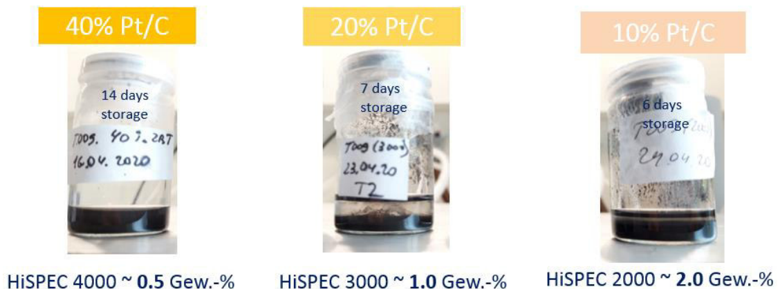
Abb. 4.4: Sedimentation der Tinten auf Basis von Katalysatorpulver mit unterschiedlicher Pt-Konzentration und unterschiedlichem Feststoffgehalt
