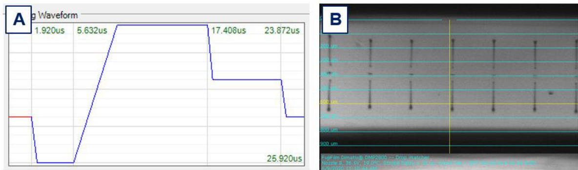
Abb. 6.2: (A) Waveform, (B) Tropfenbildung der Referenztinte T009
