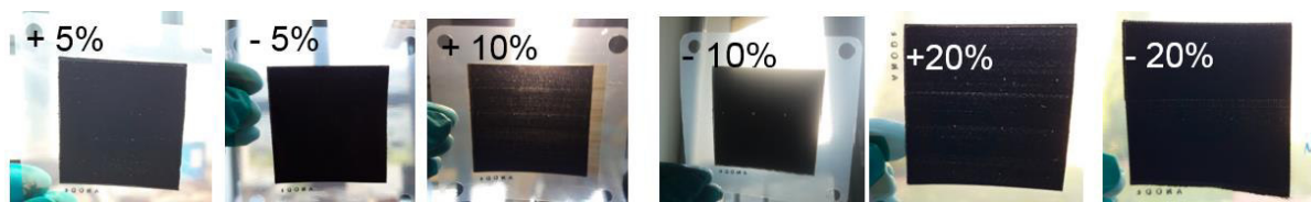
Abb. 4.9: Proben mit einem “through-plane” Ionomergradient. Fotos in Durchlichtmodus. Die Zahlen geben den Unterschied in der Ionomerkonzentration für die Schicht nahe der Membran an. Die Kathodenfläche beträgt 50 mm x 50 mm.
