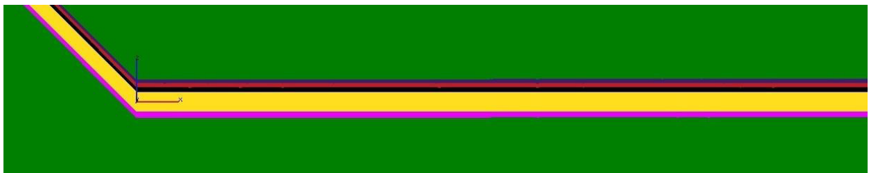
Abb. 3.2: Through-plane Gradierung der Kathoden-Katalysatorschicht mit drei Lagen (schwarz, dunkelrot, violett) gleicher Dicke.
