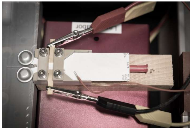
Abbildung 16: Papier- \mu FFC mit Blisterversorgung
