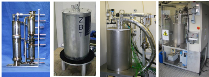
ZBT-Reformer-Systeme mit 0,3-3,0 Nm 3 H 2 /h
