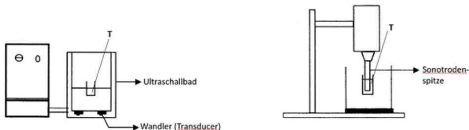
Abbildung 26: Wirkprinzip der eingesetzten Ultraschallgeräte: Ultraschallbad (links) und Sonotrode (rechts).
