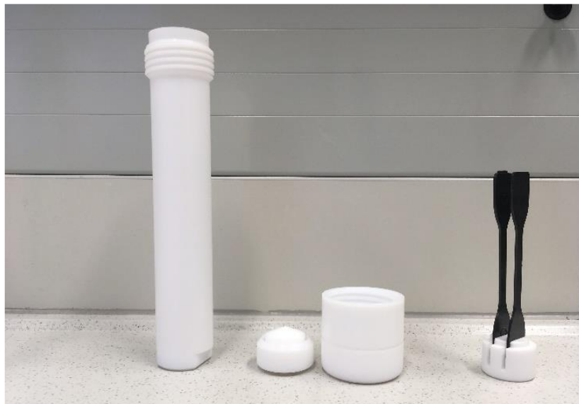
Abbildung 107: PTFE-Druckbehälter zur Auslagerung der Normprobekörper in spezifischen Einlagerungsmedien
