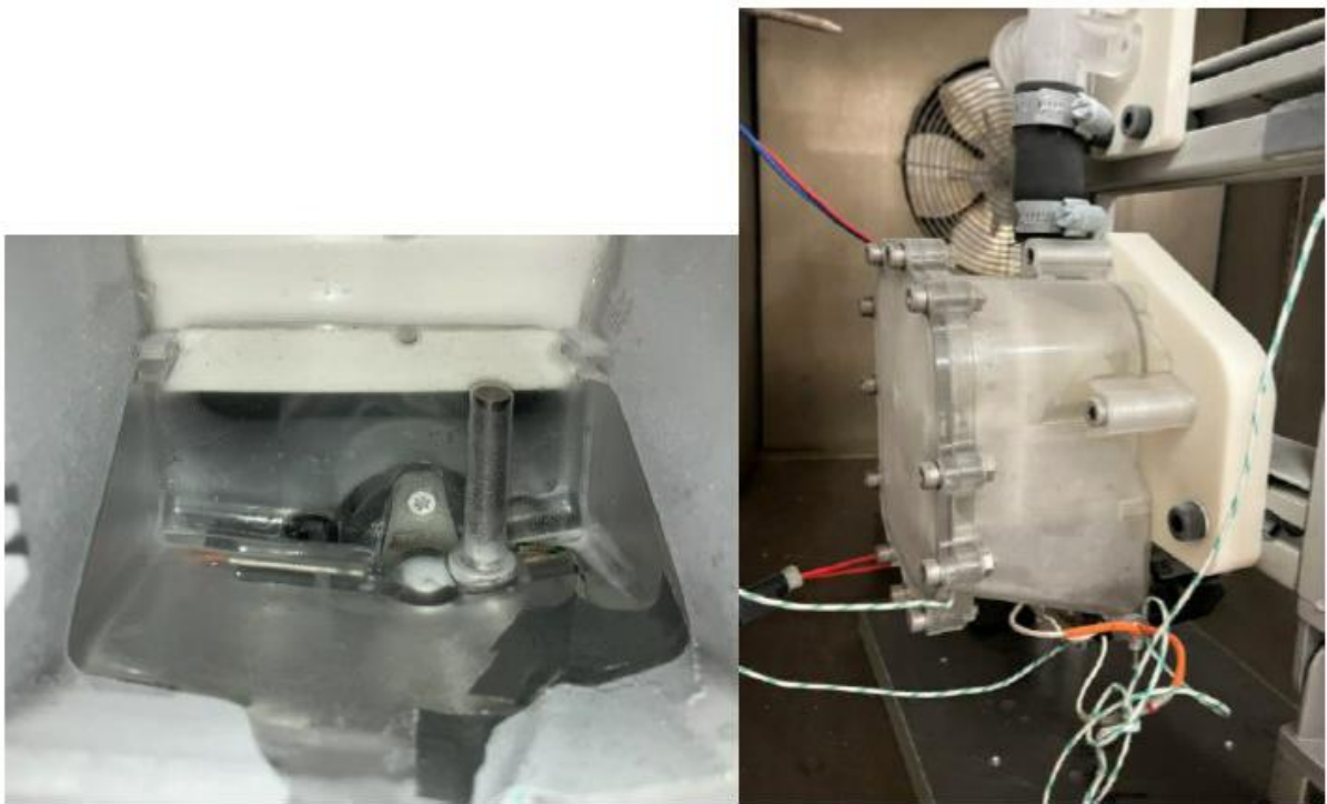
Abbildung 81: Innenraum des Abscheiders mit definierter gefrorener Wassermenge (l); Wasserabscheidemodul im Klimaschrank bei -40°C (r).
