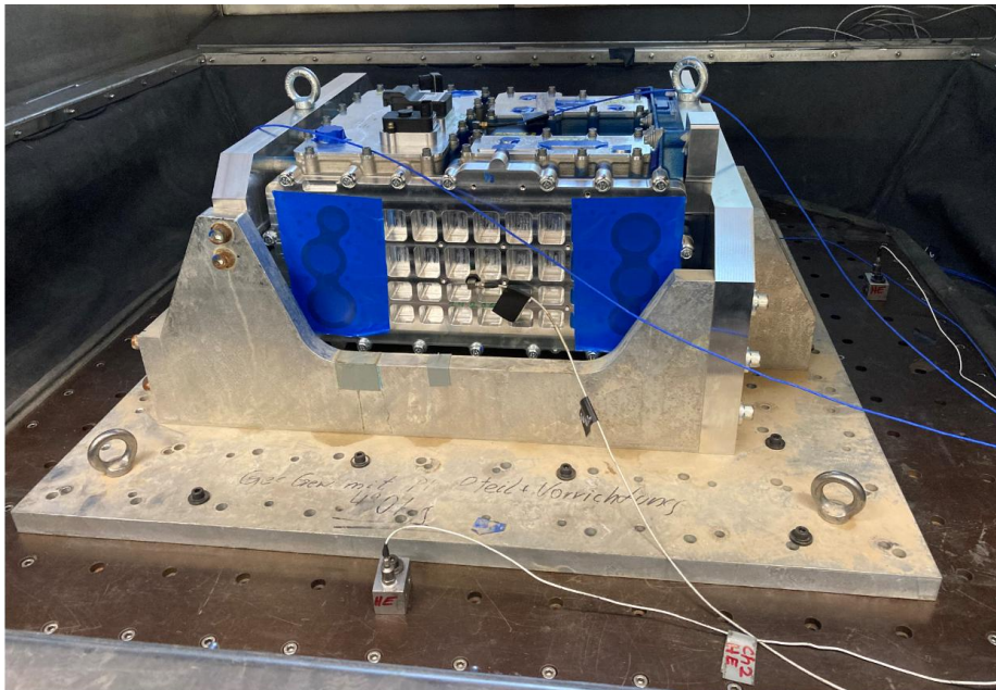
Abbildung 36: Versuchsaufbau für Vibrations-Tests nach BMW Group Standard GS 95024-3-1. Stack mit Haltevorrichtung und Beschleunigungssensoren.
