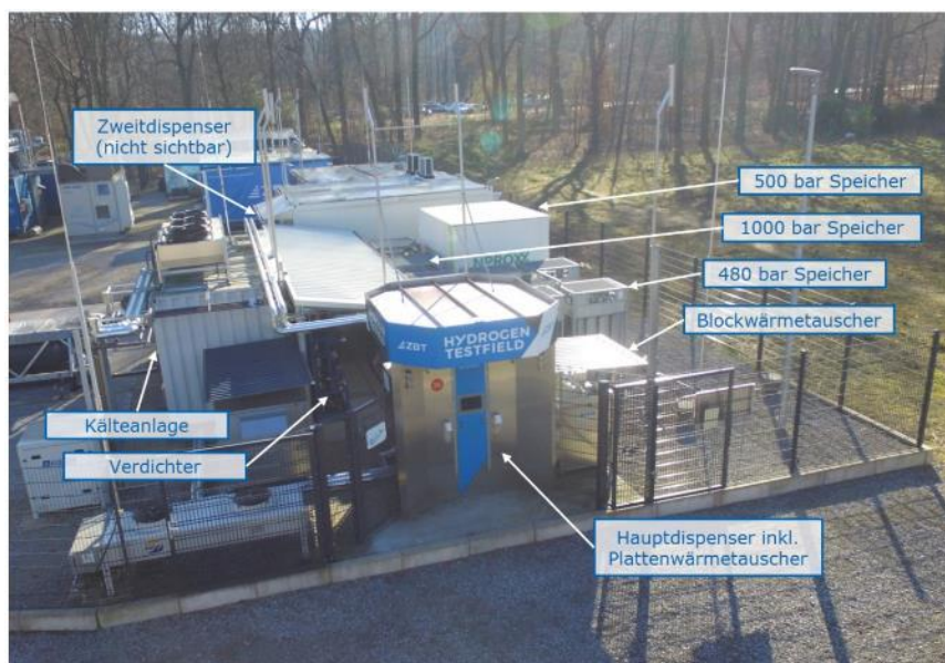
Abbildung 2: Anordnung der Komponenten im Hochdruckteststand
