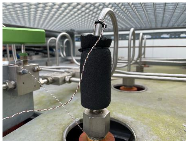
Abbildung 10: Nachgerüstete Messstellen am Hochdruckspeicher (Segmente 6-7)
