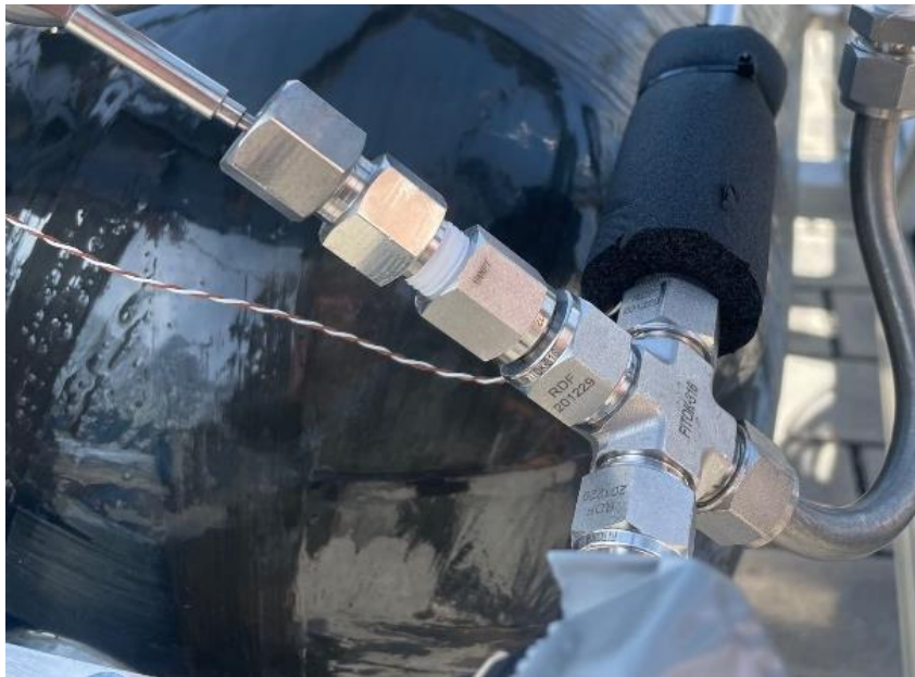
Abbildung 11: Nachgerüstete Messstelle 22 am 35 MPa Testtank
