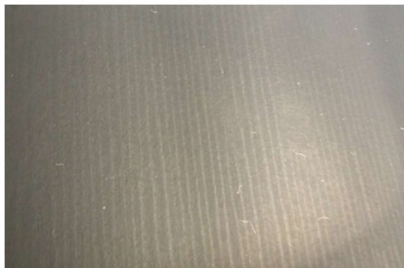
Abbildung 2.8: Beschichtung mit Ketjenblack EC-600JD bei angepasster Suspensionszusammensetzung und Beschichtungsparameter
