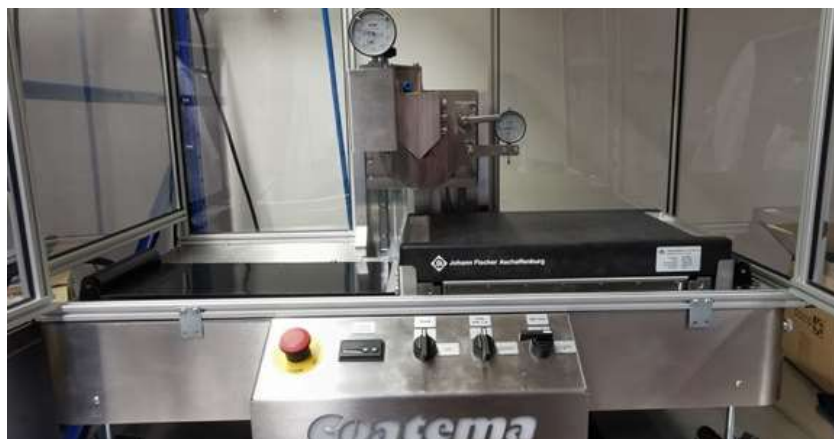
Abbildung 2.2: Schlitzdüsenanlage mit Umhausung
