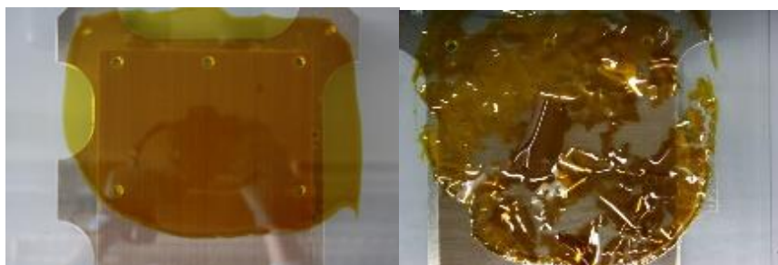
Abb. 7: Membranherstellung der quaternisierten Blockcopolymere: links ist die Nassschicht abgebildet und rechts die Membranschicht nach dem Trocknen.
