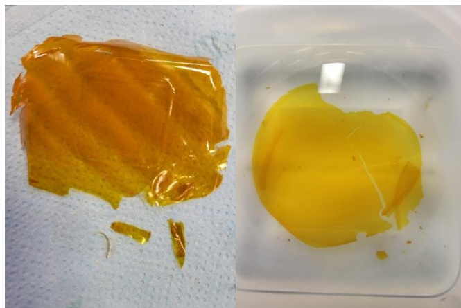
Abb. 16: KE105/4QA_4B und KE105/4QA_4d zeigen Instabilität in 1 M KOH Lösung.
