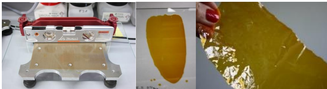
Abb. 10: Membranherstellung der HP-Polymere mittels Rakelverfahren.
