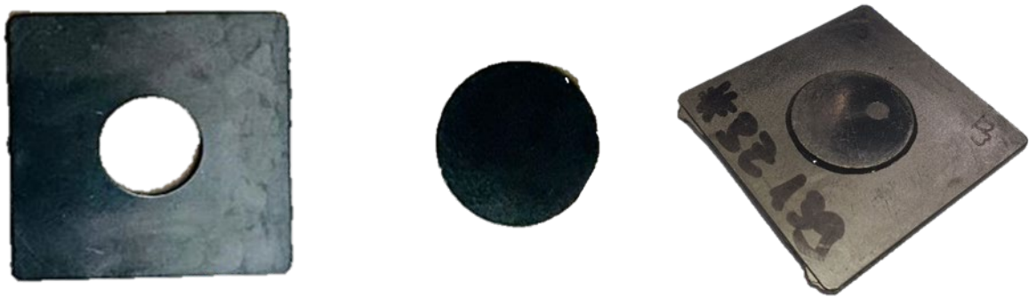
Abbildung 56: Einzelkomponenten einer Münzprobe aus Bio-PE links und Mitte, geklebte Münzprobe rechts
