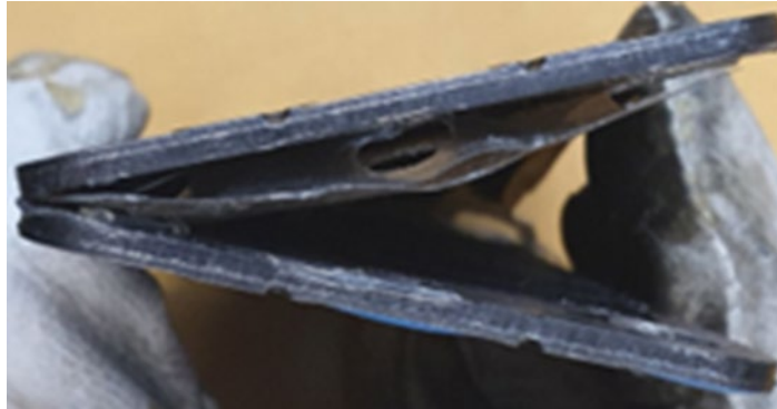
Abbildung 60: Manuelles Trennen von MEA und Compound nach Lagerung bei 140 °C im Ofen
