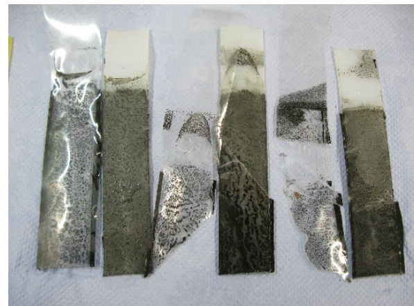
Abbildung 48: Schälldiagramm und Bruchbild nach sechs Wochen bei 85 °C in Wasser – PES-PET
