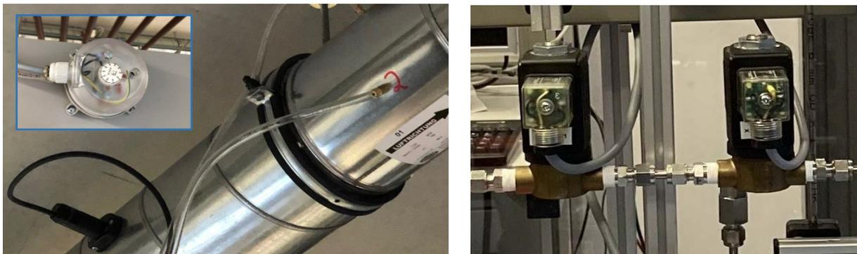
Abbildung 2.3.2: Abluftüberwachung am  $\mu$ PEMFC Hybridsystem Teststand (links); Redundante NC-Ventile innerhalb der Wasserstoffleitungen des Teststandes (rechts).
