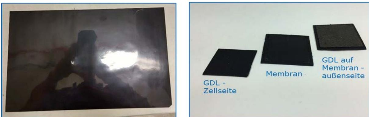
Abbildung 2.4.7: Membransheet von Gore (links) und auf Zellmaßstab konfektionierte Gasdiffusionslagen und Membranen (rechts)
