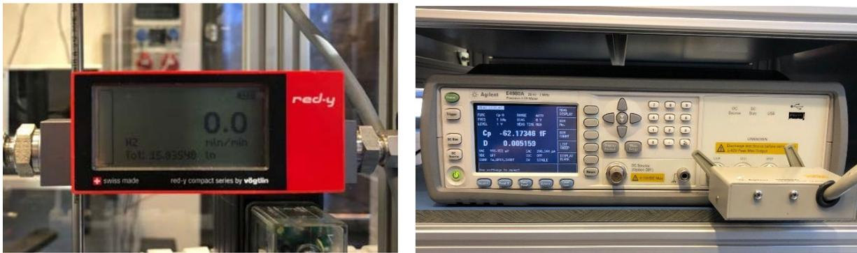
Abbildung 2.3.5: Red-Y Wasserstoffdurchfluss-Messung (links) und Zellinnenwiderstandsmessgerät (rechts)
