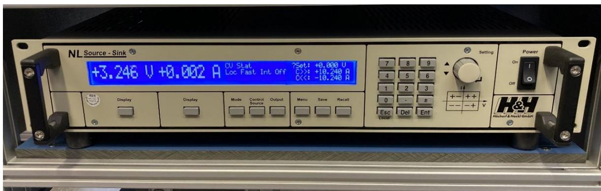
Abbildung 2.3.4: Elektronische Last für die Zellvermessung und zum Be- und Entladen von Akkus
