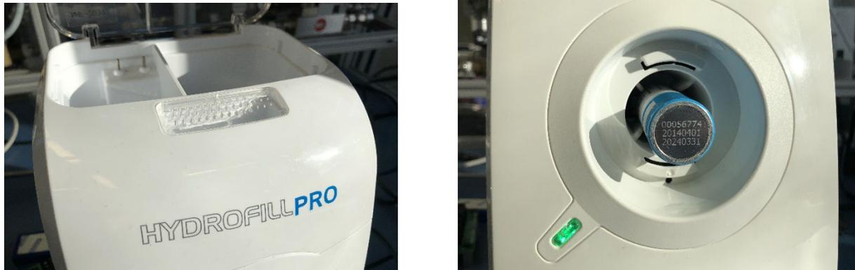
Abbildung 3.7: Hydrofill Pro VE Wasser-Tank (links) & Aufladung eines Metallhydridspeichers (rechts)
