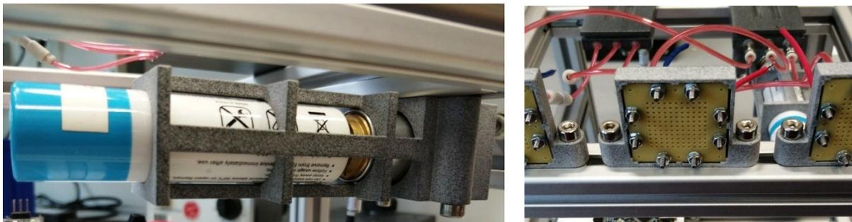
Abbildung 2.6.3: Am System montierte, und in die Wasserstoffversorgung integrierte Versorgungsbaugruppe (links) sowie Zellbaugruppen (rechts).
