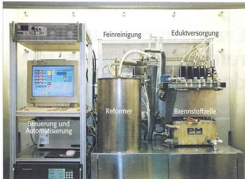
**Bild 1.** Laboraufbau des kombinierten Systems aus Brennstoffzelle und Gasprozessor mit SelOx
