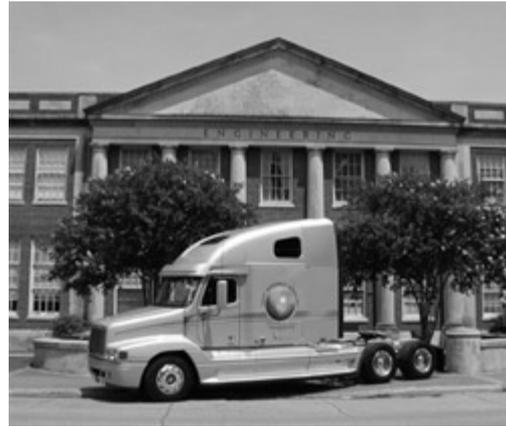
**Abb. 2:** Foto eines Lkw der Firma Freightliner mit Brennstoffzellen-APU
