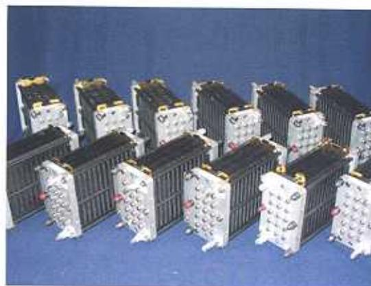
Abb. 4: Serienaufbau von Brennstoffzellenstacks der Leistungsgröße 250–300 W
