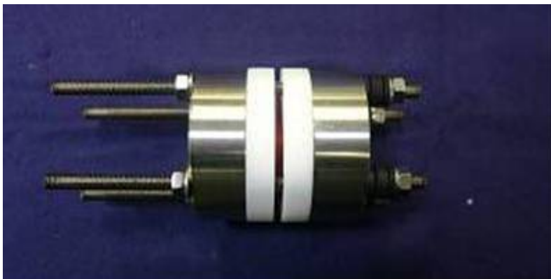
Abbildung 17: Dichtung mit Hilfe von PTFE und Edelstahlplatten verpresst
