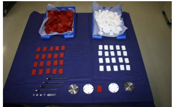
Abbildung 16: Dichtungsprobenkörper für die Auslagerung
