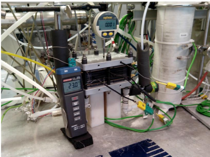
Abbildung 2.32 Messaufbau für die thermische Ausdehnung
