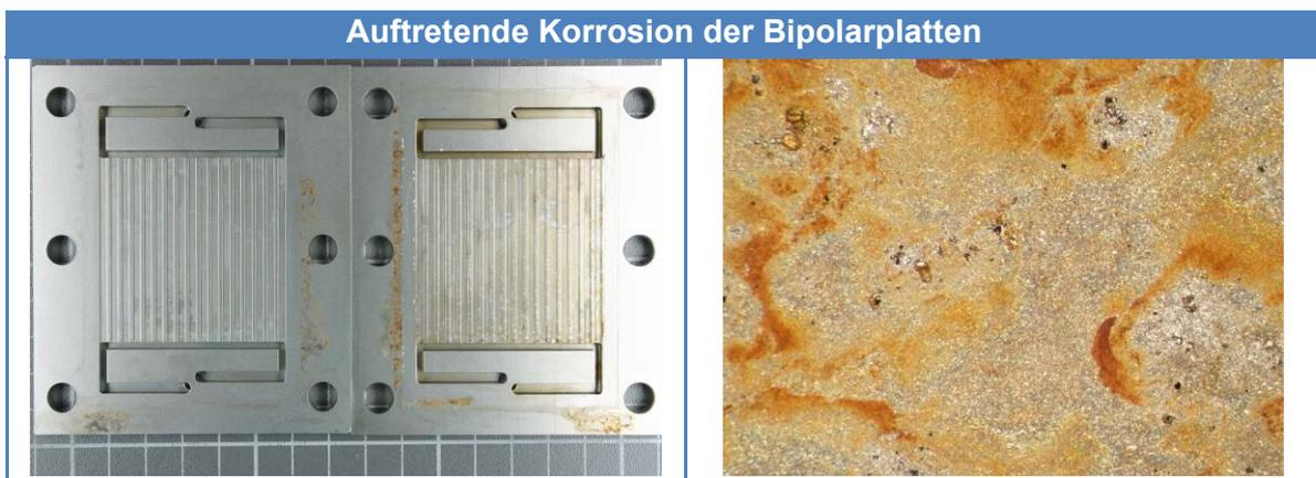
**Tab. 38: Auftretende Korrosion der Bipolarplatten nach Betrieb.**
