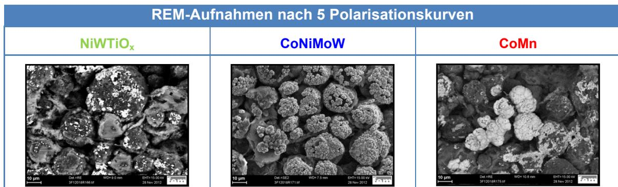
**Tab. 15: REM-Aufnahmen von der NiWTiO<sub>x</sub>-, CoNiMoW- und CoMn-Schicht auf GK Substrat nach 5 PK.**
