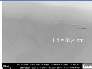
REM-Aufnahmen: MV.60 15x mit Ir(acac)<sub>3</sub> beschichtet bei 1-stündiger 400°C Sinterung (links)
