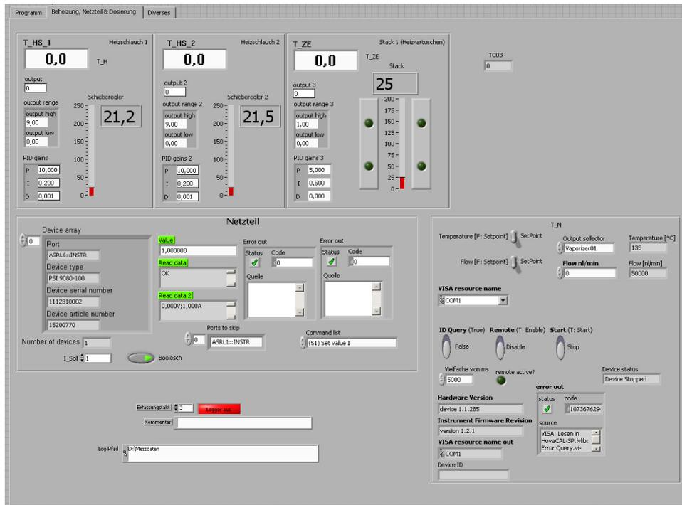
**Abb. 36: Temperaturregelung unter LabVIEW**
