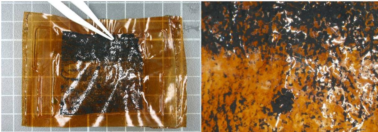
**Abb. 43: Membran nach dem Betrieb in der Zelle (Kathodenseite)**
