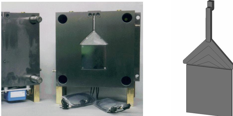
Abb. 7.16: Spritzgießwerkzeug "Platte".
