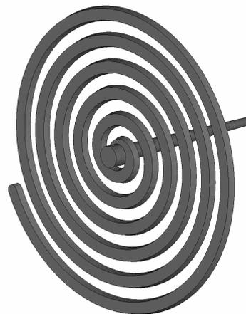
Abb. 7.13: Spritzgießwerkzeug "Fließspirale".
