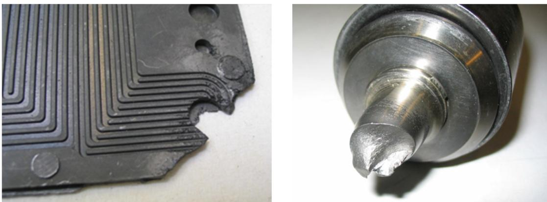
*Abb. 1.2: Fertigungsprobleme beim Spritzgießen von Bipolarplatten.
