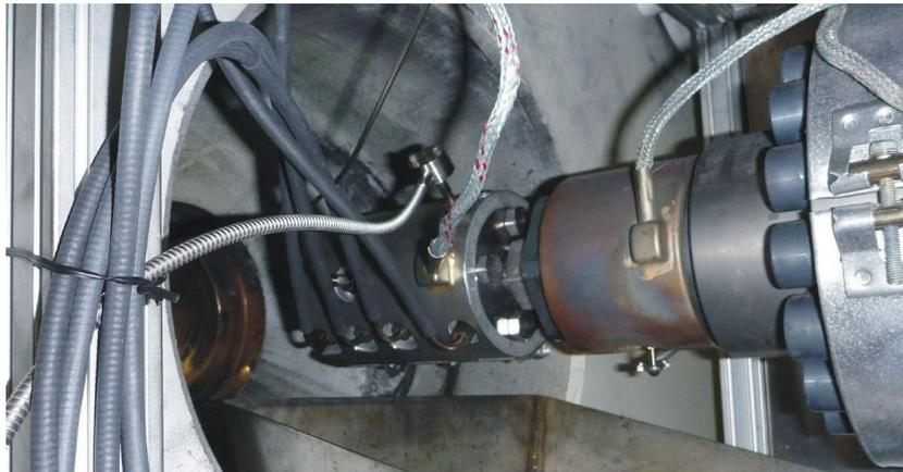
Abb. 5.2: Einsatzbereite Rheologiemessdüse mit allen Sensoren und Heizband.
