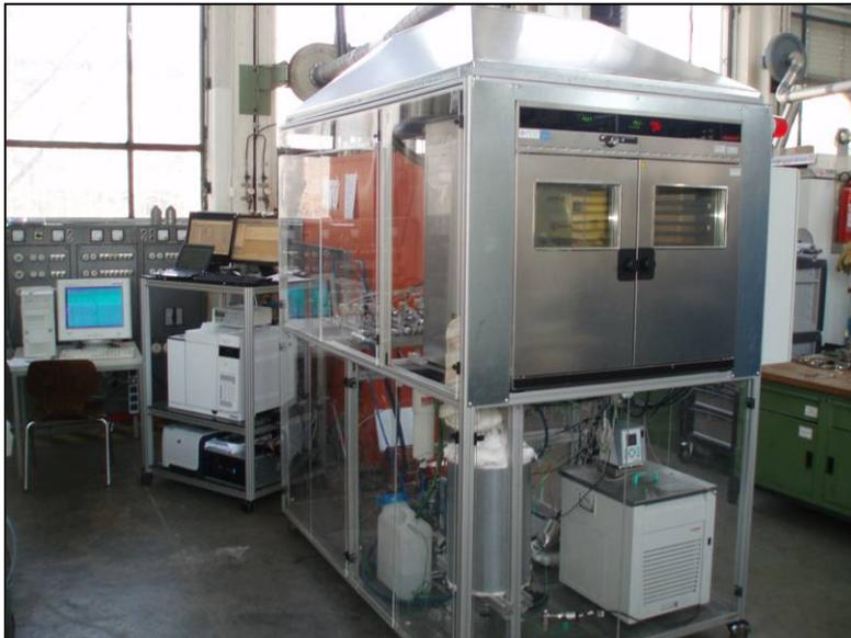
**Abbildung 3-59: Gaspermeationsanlage des Instituts für Verfahrenstechnik**
