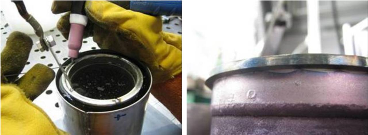
**Abbildung 3-81: Einschweißen des Abstandsringes an das Membranrohr**
