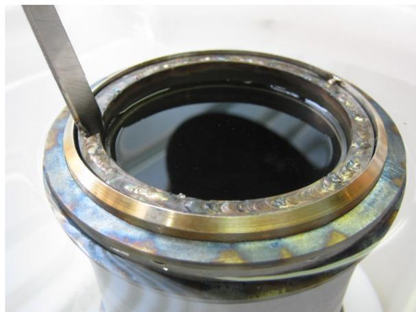
**Abbildung 3-82: Einschweißen des Membranrohres in das Außengehäuse**
