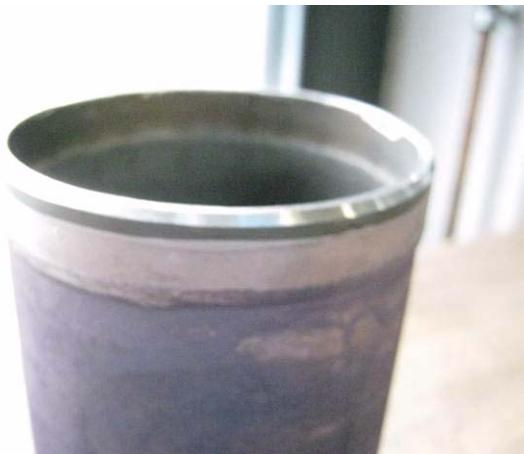
**Abbildung 3-80: Gekürztes Membranrohr mit Fasen**
