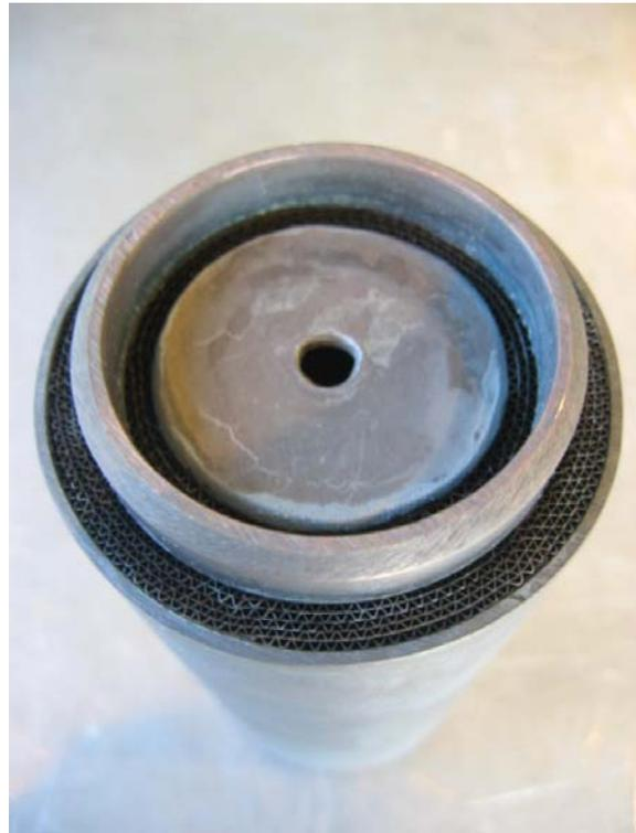
**Abbildung 3-4: Reformer-Brenner-Einheit als Doppelringspalt**
