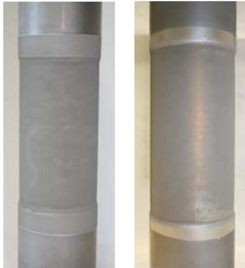
**Abbildung 3-37:** Die Trägerrohre mit Pd-Schicht: YSZ-Schicht (Probenbezeichnung 1603) links, TiO<sub>2</sub>-Schicht (Probenbezeichnung D1) rechts.
