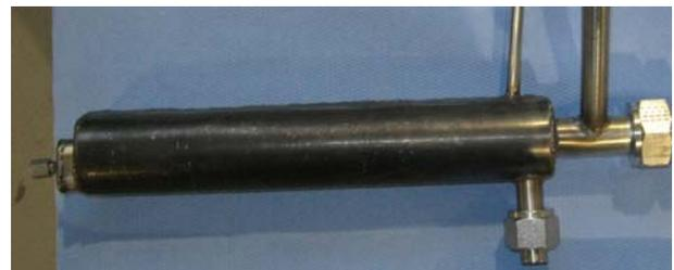
Abbildung 3-30: Kombinierte Verdampfung und Überhitzung mit Rauchgas
