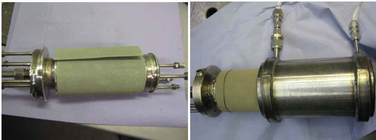
Abbildung 3-85: Einbau des Metallschaums
