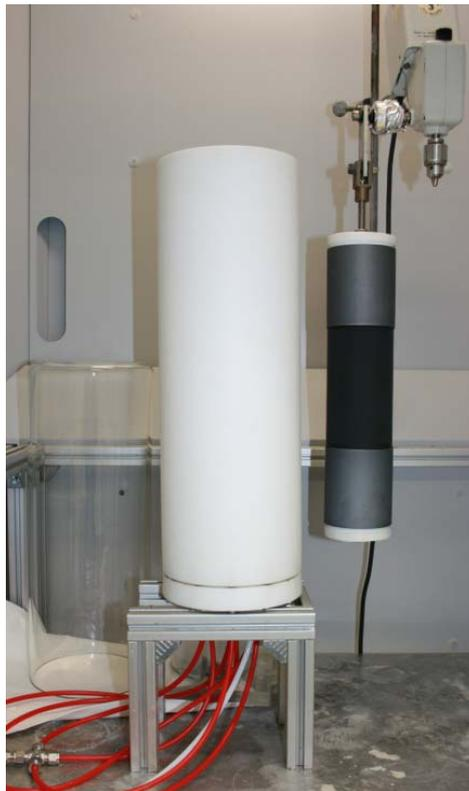
**Abbildung 3-36:** Apparatur aus Teflon zur Außenbeschichtung der Trägerrohre durch ELP und eine Trägermembran mit TiO<sub>2</sub>-Zwischenschicht montiert an einem Motor mit Exzenter.
