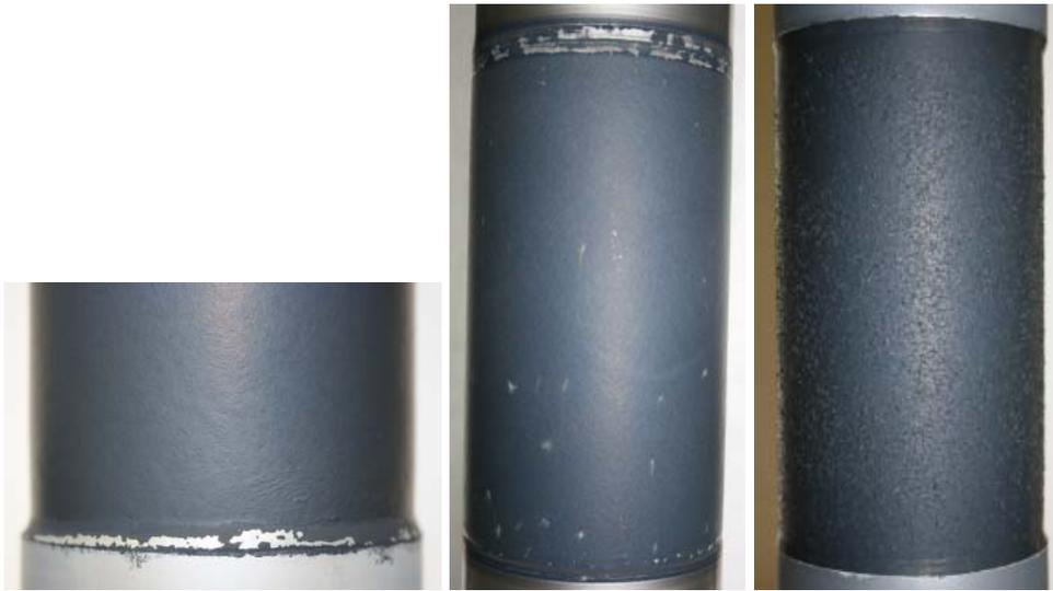
**Abbildung 3-35:** Oberflächendefekte auf dem Trägerrohr mit TiO<sub>2</sub>-Zwischenschicht. Von links: Abplatzung der keramischen Schicht an der Schweißnaht, Abplatzung der TiO<sub>2</sub>-Schicht nach der Reinigung im Ultraschallbad, Abplatzung nach dem Trocknungsvorgang bei 150°C.
