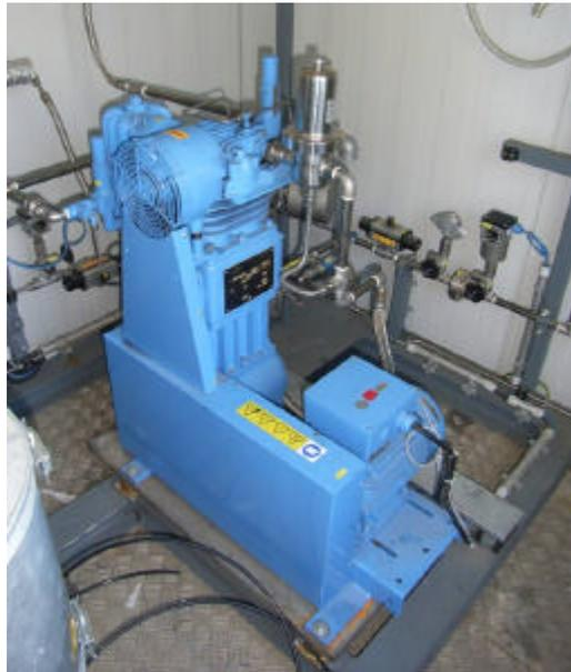
Abbildung 60: Hubkolbenverdichter
