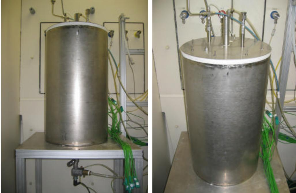
Abbildung 14: ZBT 5 kW<sub>H<sub>2</sub>,th</sub> Biogas-Dampfreformersystem
