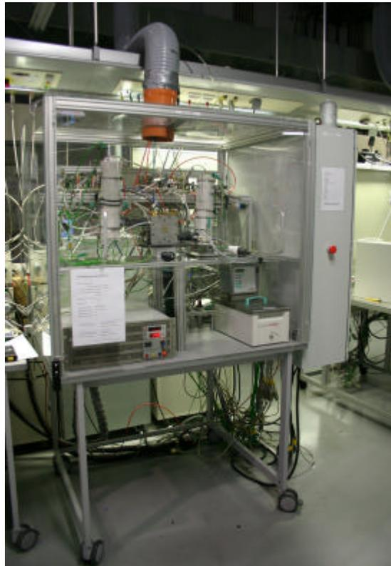
Abbildung 28: ZBT Einzellerteststand
