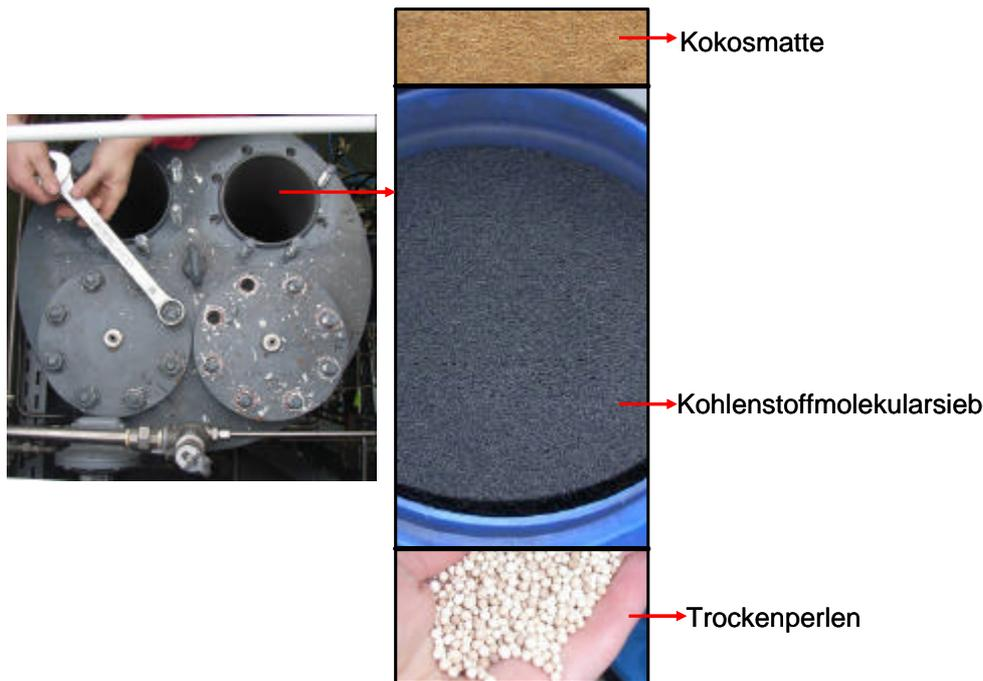
Abbildung 62: Befüllen der Adsorberkolonnen zur Abtrennung von Kohlendioxid.
