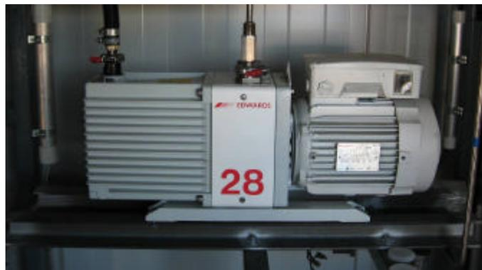
Abbildung 63: Vakuumpumpe zur Desorption von Kohlendioxid.
