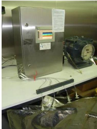
Abbildung 74: Externe Gasmessstrecke zur Bestimmung von  $\text{CH}_4$ ,  $\text{CO}_2$ ,  $\text{O}_2$  und  $\text{H}_2\text{S}$ , Firma Awite.
