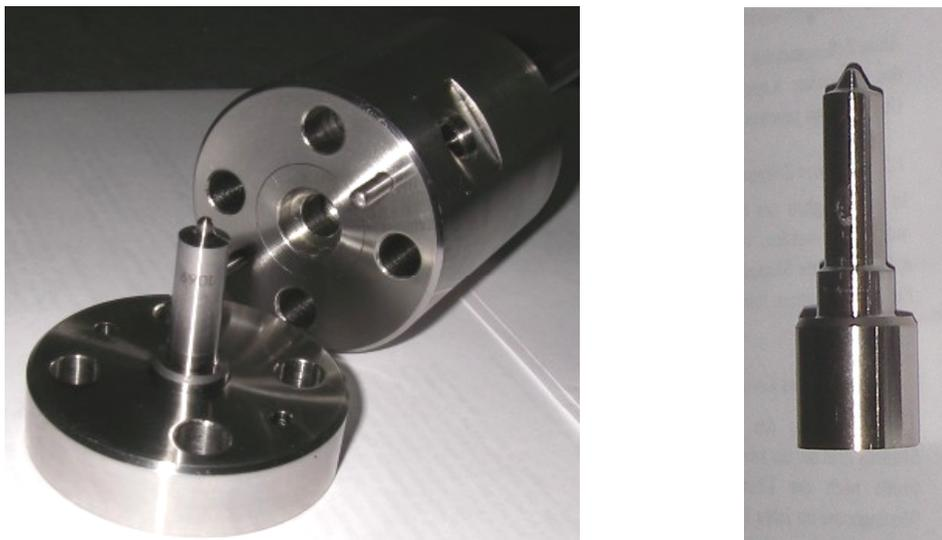
**Abbildung 3-20: Foto des ersten Injektor-Funktionsmoders und der verwendeten Treibdüse ( $d=236 \mu\text{m}$ )**
