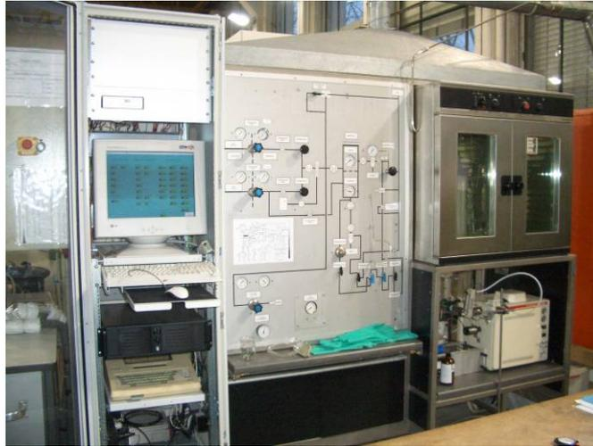
**Abbildung 3.48: Gaspermeationsanlage des Instituts für Verfahrenstechnik**
