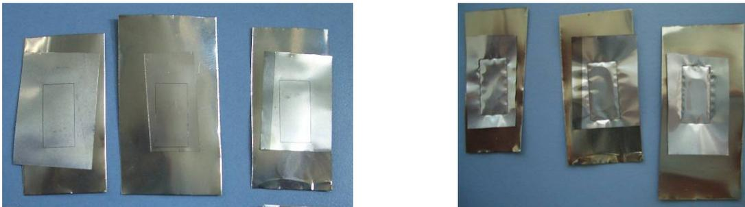
**Abbildung 3.73: Pd-V-Membranen verschweißt auf einer 40 µm starken und weichgeglühten Edelstahlfolie; vor (links) und nach (rechts) H<sub>2</sub>-Atmosphäre (350°C, 3 bar<sub>abs</sub>)**
