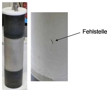
**Abbildung 3.44: Oberflächendefekte auf einer mit Pd beschichteten Rohrmembran**
