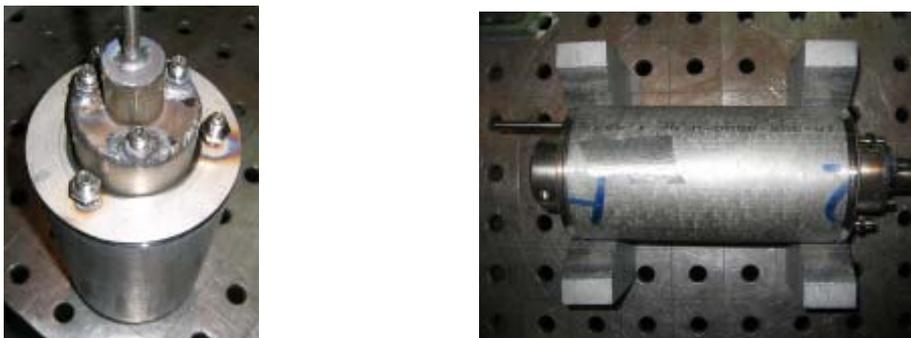
**Abbildung 3.25: Fertigung des Membranreformers**
