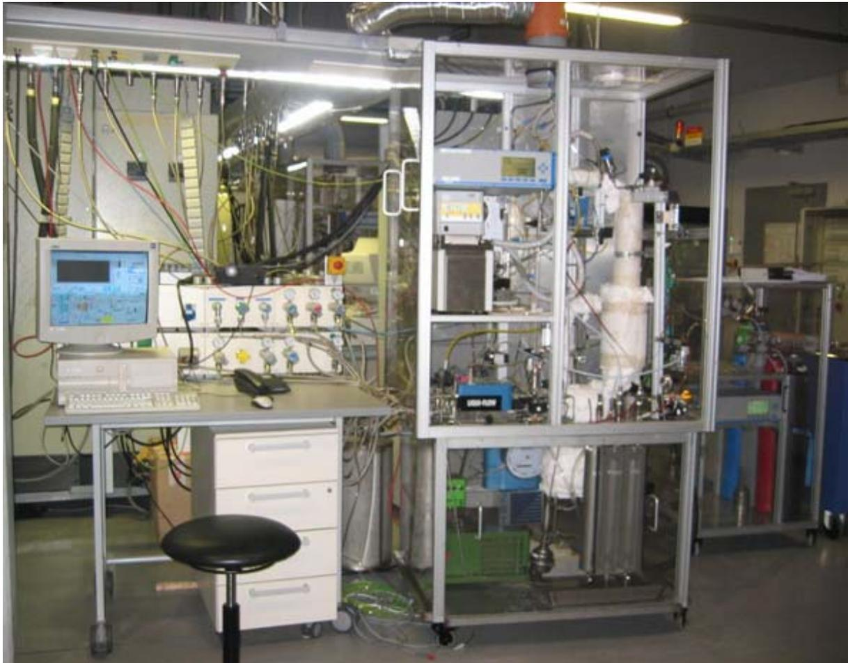
**Abbildung 3.26: Teststand für den Biodiesel-Membranreformer im ZBT-Labor**
