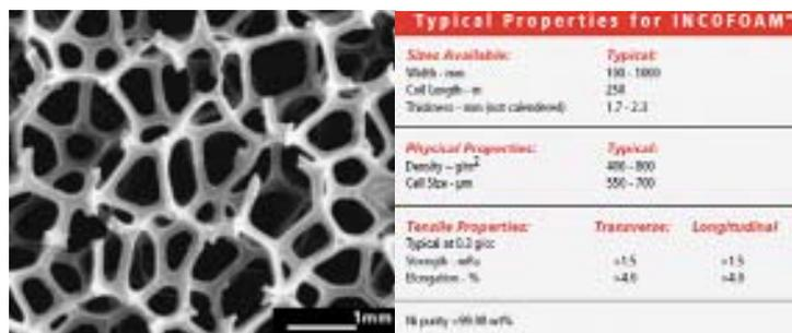
Abbildung 3.19: Datenblattausschnitt des Metallschaums „Incofoam“
