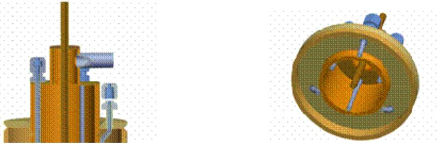
**Abbildung 3.23: Detail Membranreformer-Kopf**
