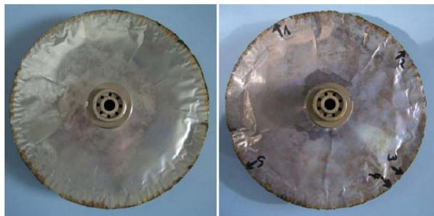
**Abbildung 3.67: Membrankissen vor (links) und nach (rechts) H<sub>2</sub>-Beaufschlagung**
