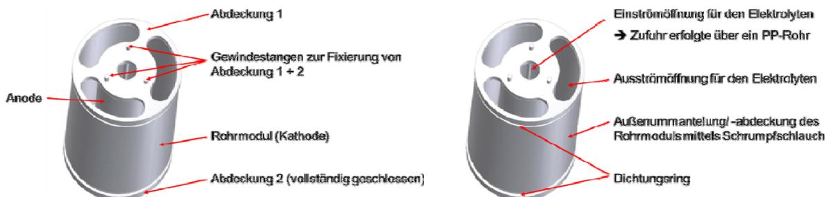
Abb. 4.7-5: Vorrichtung zur Beschichtung des Rohrmoduls mit Nickel und Palladium
