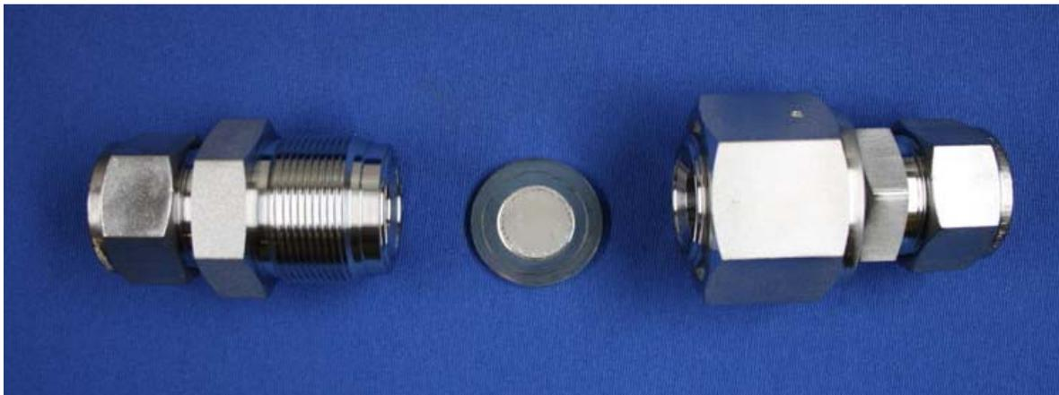
Abb. 4.5-1: VCR-Verschraubung mit Membranprobe
