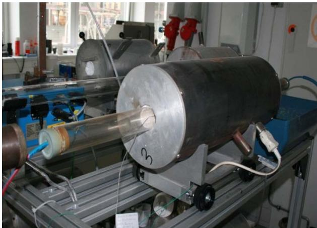
Abb. 4.3-1: Röhrenofen zur Wärmebehandlung der Multilayer
