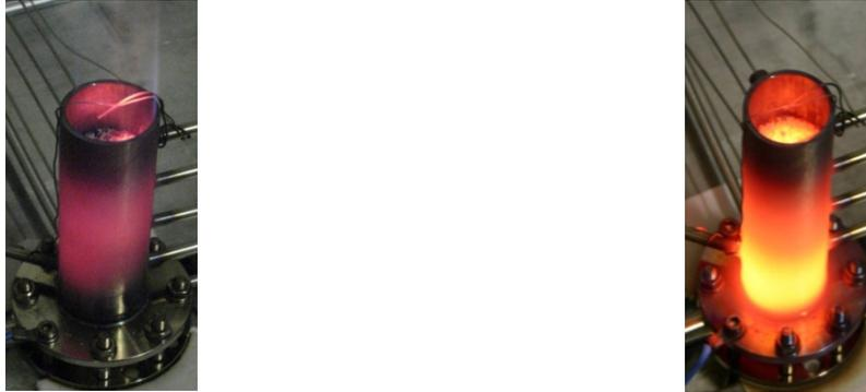
Abb. 4.6-11: Vergleich Porenkörper in Mischzone (links) mit spezieller Mischerstruktur bei identischem Betriebspunkt
