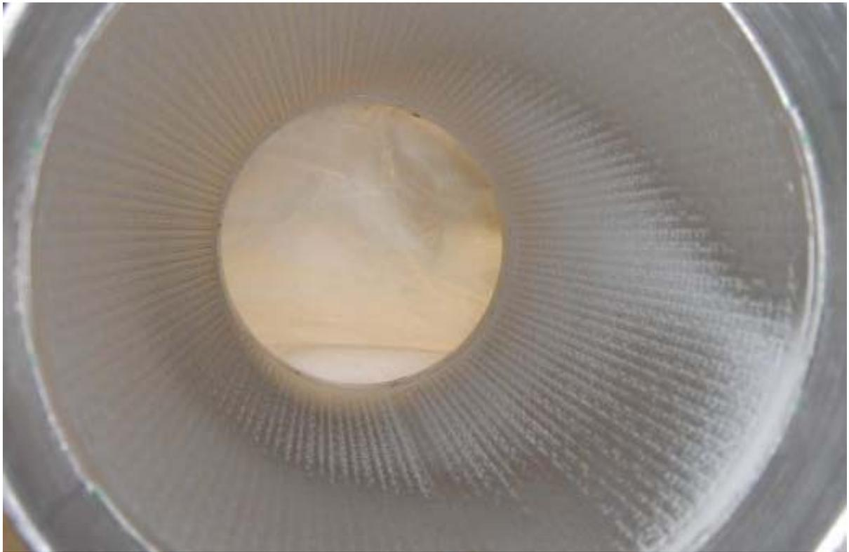
Abb. 4.7-2: Oberfläche der Beschichtung des Membranrohrmoduls
