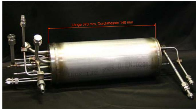
Abb. 4.7-10: Membranreformer - Zusammenbau
