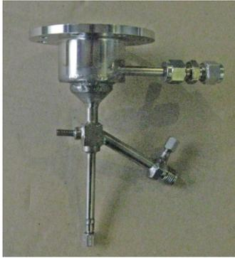
Abb. 4.6-8: Brenner - Unterseite
