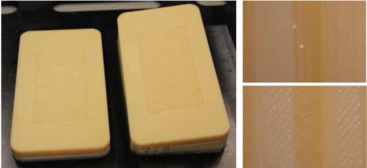
Abbildung 3.11: BPP-WKZ aus Wachs; links: grundplattenparallele und um x=8^\circ / y=8^\circ gedrehte Bauweise; rechts: Oberflächen
