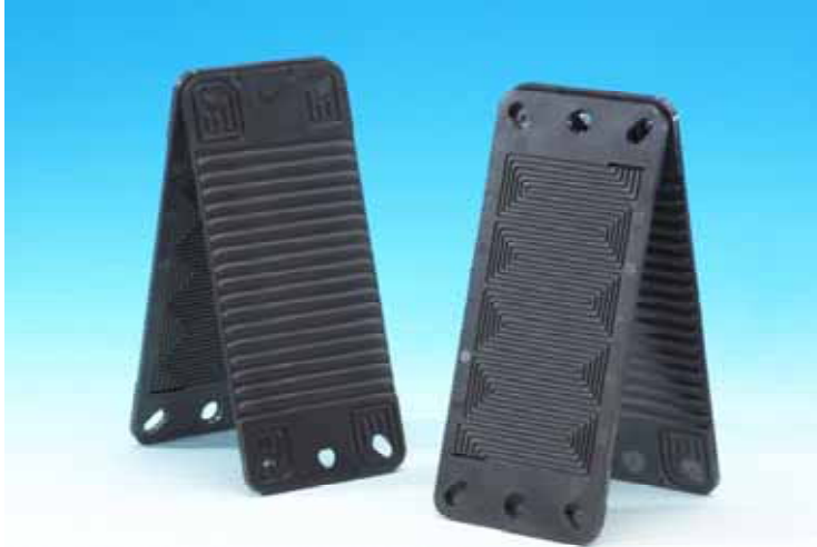
Abbildung 2.1: Spritzgegossene Bipolarplatte einer PEM-Brennstoffzelle (rechts: Flowfieldstruktur) [Quelle: ZBT, Duisburg]
