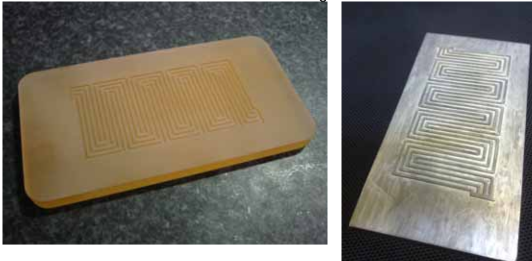
Abbildung 5.18: SLA RP-Positiv von NRU 001 aus AccuGen 100 HC und daraus hergestellte Galvanoform 007
