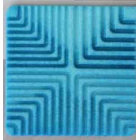
Abbildung 4.19: lackierter Polyamid-Testkörper mit Benetzungsproblemen
