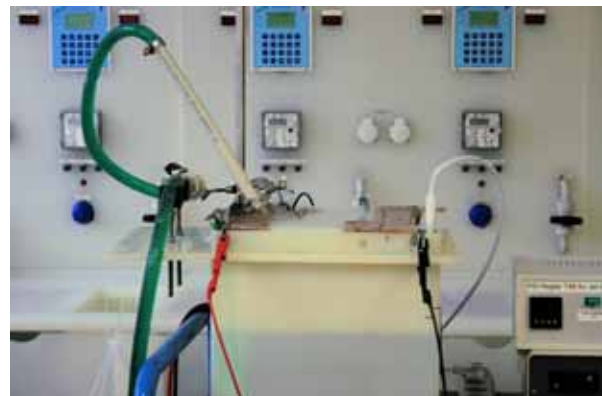
Abbildung 4.29: Elektrolytwanne mit stufenloser Anströmung
