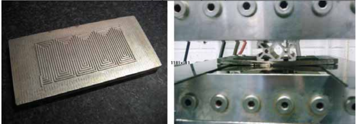
Abbildung 5.22: Galvanoform 004 auf Wachsbasis und mechanisches Richten einer Galvanoform in der 100 to. Hydraulikpresse
