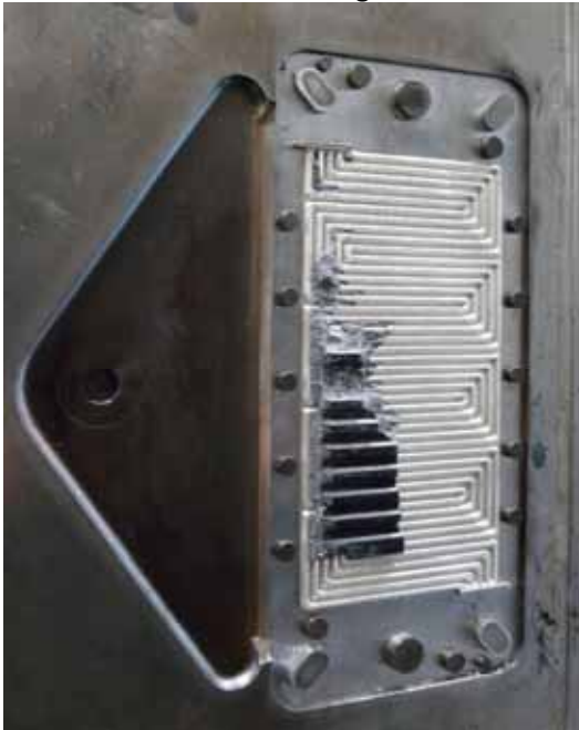
Abbildung 5.28: Teilweise schlechte Entformbarkeit mit Galvanoform 005 und Ausbrüche im Flowfeldbereich sowie Haarrisse im Angussbereich des Gaseinlassschlitzes
