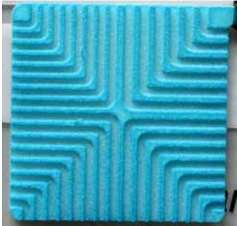
Abbildung 4.18: lackierter Polyamid-Testkörper ohne Benetzungsprobleme
