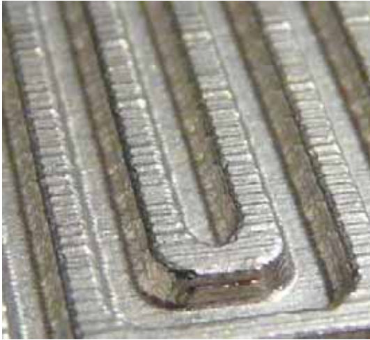
Abbildung 5.30: Strukturierung von Galvanoform 005 & Nutgrund einer BPHP aus Galvanoform 005
