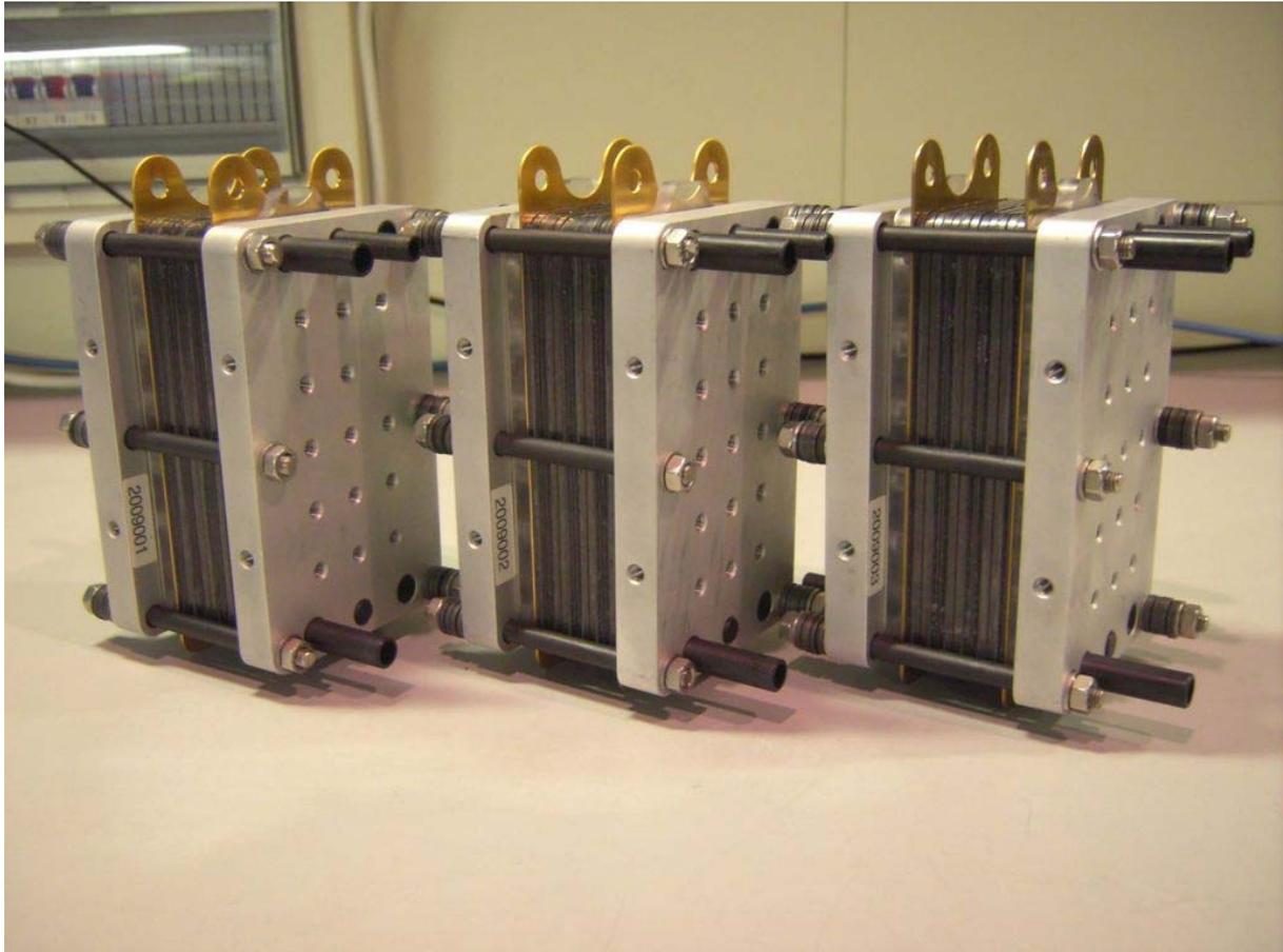
Abbildung 8: Die drei Stacks des Langzeitversuches 3
