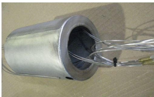
Abbildung 4: Reformerreaktor mit aufgeschweißten Thermoelementen
