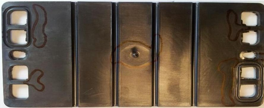
**Abbildung 79: Temperierbare BPHP mit Rissen im Anguss- und Portbereich**
