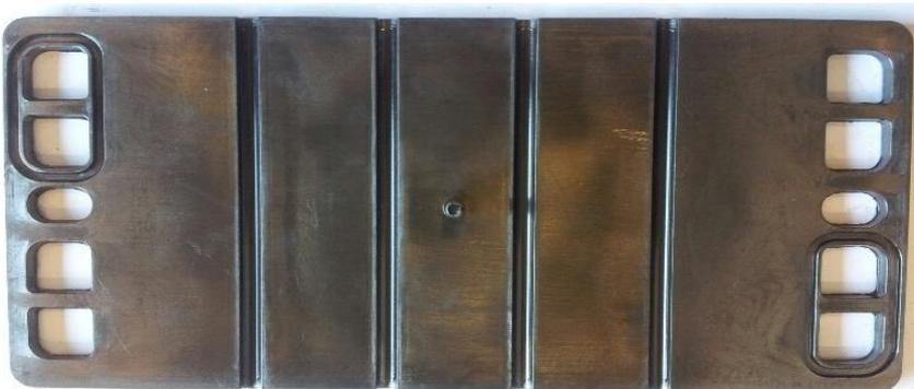
**Abbildung 81: Isotherm hergestellte BPHP guter Qualität**
