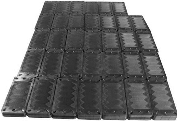
**Abbildung 1:** Unter Großserienbedingungen produzierte HT-Bipolarplatten (ca. 3.300 bar maximaler Einspritzdruck bei Zylindertemperaturen über den zulässigen Verarbeitungstemperaturbereich des PPS (410 °C) und isothermer Werkzeugtemperierung)
