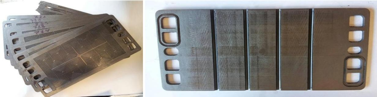
**Abbildung 87: Nachbearbeitete Bipolar-Halbplatten mit einseitiger Temperierstruktur**
