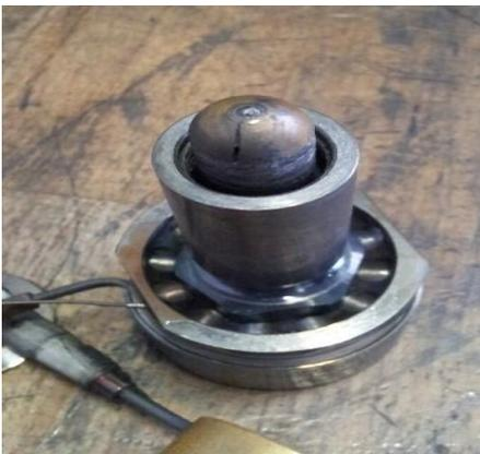
**Abbildung 75: Heißkanaldüse nach Demontage der Kappe infolge von HT-Spritzgießversuchen**
