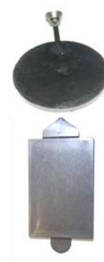
**Abbildung 6:** Labormesskneteter, Kolbenspritzgießmaschine, Probekörper  $\varnothing = 30 \text{ mm}$  &  $38 \times 25 \times 2 \text{ mm}^3$
