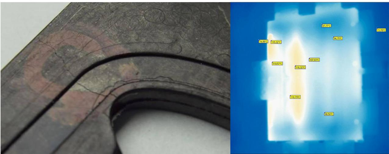
**Abbildung 60: Risse im Portbereich der Versuchplatte und Thermografieaufnahme des Werkzeugs**
