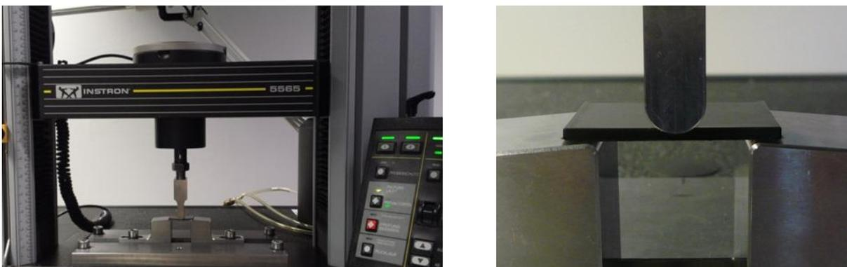
**Abbildung 8: Prüfaufbau 3-Punkt-Biegeversuch**
