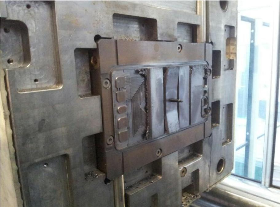
**Abbildung 80: Asymmetrisch gefüllte Form der temperierbaren BPHP**
