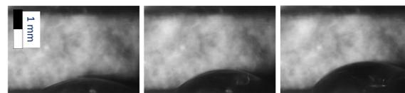
Test-Brennstoffzelle mit optisch zugänglichem Kathodenkanal (rechts) und erste Flüssigwasser-Visualisierungen im Kathodenkanal bei Brennstoffzellenbetrieb
