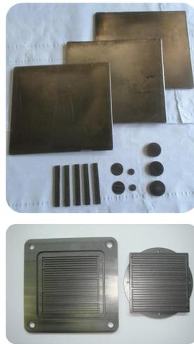
Abb. 3: Gepresste Platten und gefräste Probekörper & Bipolarplatten
